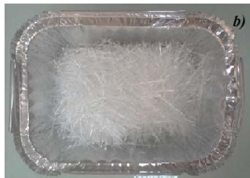
Fig.V.4 : Fibres de verre : (a) roving de fibre de verre, (b) fibres de verre coupées.
