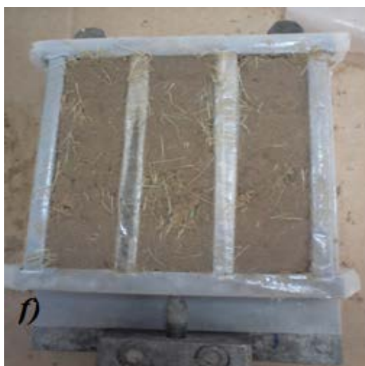
Fig.V.16 : Etapes de moulage de béton polymère par contact.
