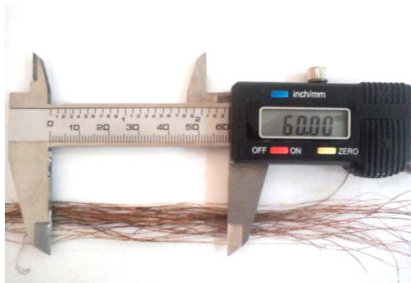
Fig.V.13 : Mesure de la longueur des différentes fibres utilisées.
