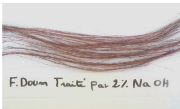
Fig. V.11 : Fibres de Doum extrait par 2% NaOH.
