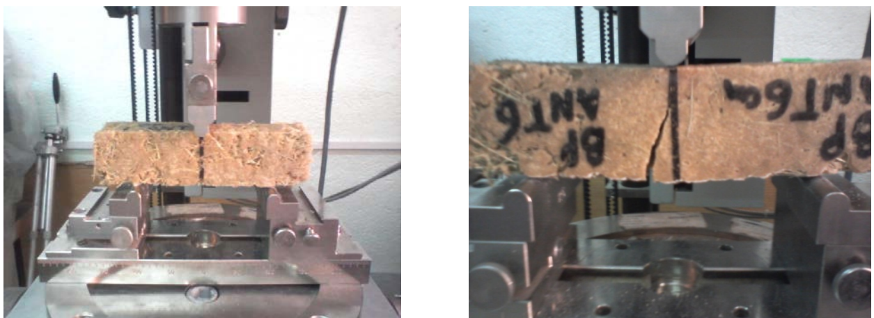
Fig.V.19 : Essai de FTP sur des éprouvettes lissés en BP.
