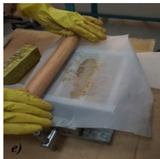
Fig.V.16 : Etapes de moulage de béton polymère par contact.
