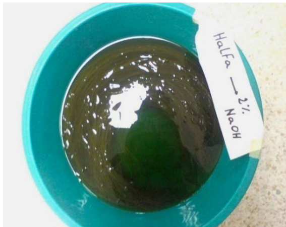
Fig. V.8 : Traitement de fibre Alfa par NaOH.
